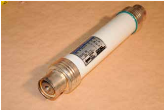
Smeltveiligheid voor hoogspanning met centraal in de voet de 'pin' die naar buiten springt bij kortsluiting.
