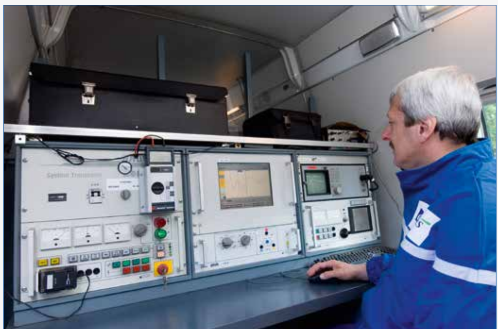
Gesofisticeerde meetapparatuur om kabelfouten op te sporen, is ondergebracht in een bestelwagen. Dit maakt een snelle interventie mogelijk bij kabelfouten.
