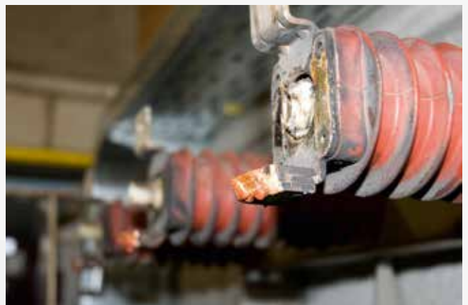
Detail van de beschadigde contactklemmen. Bedenk dat het ontbrekende koper in een fractie van een seconde is gesmolten en in de omgeving is gespat!
