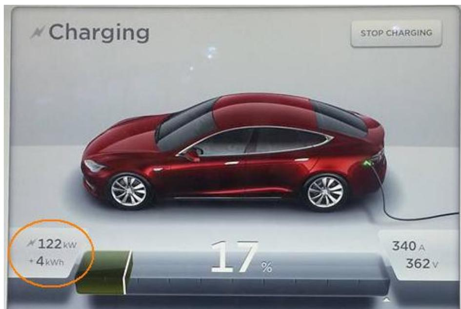
L'écran de contrôle de la voiture indique l'électricité absorbée depuis le début de la recharge. Il faut majorer ce chiffre de 10% maximum pour connaître l'électricité réellement consommée par la voiture à cause des pertes en chaleur dans le chargeur embarqué.
